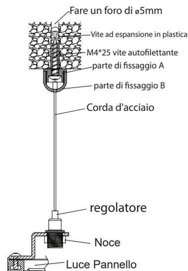
Se la superficie di installazione è troppo stretta, suggeriamo di avvicinare le due parti di fissaggio, fare riferimento al disegno sotto.
