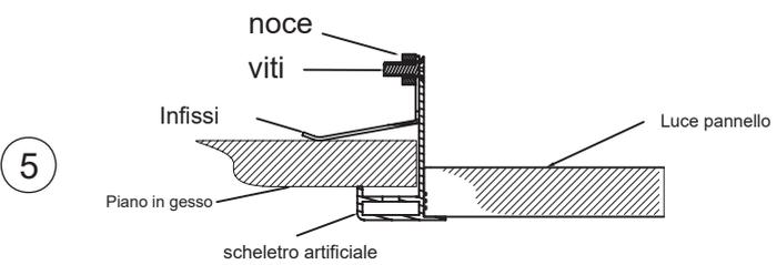
Disegno in sezione dell'installazione del soffitto in cartongesso
