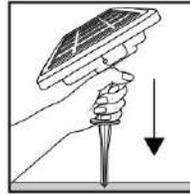
1A.\* Per l'installazione a terra, montare il picchetto alla parte corrispondente sul retro del pannello solare e fissarlo con la vite inclusa. Piantare il paletto nel terreno per completare il montaggio.
