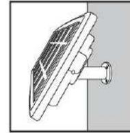
1B.\* Per l'installazione a parete montare l'accessorio relativo alla parte corrispondente sul retro del pannello solare e fissarlo con la vite inclusa.
